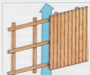
Дополнительная вертикальная обрешетка дает возможность клиновыми компенсировать неровности стены и вентилировать зашитый объем.
